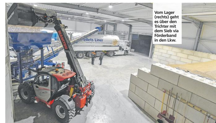
Vom Lager (rechts) geht es über den Trichter mit dem Sieb via Förderband in den Lkw.
