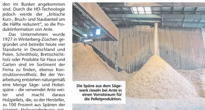
Die Späne aus dem Sägewerk rieseln bei Ante in einen Vorratsraum für die Pelletproduktion.
