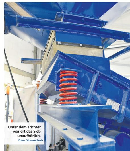
Unter dem Trichter vibriert das Sieb unauffällig. Fotos: Schmalenbach
